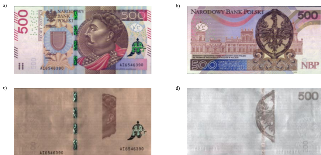
Rys. 1 Banknot pięćset złotych, podgląd na podstawie danych z kamer hiperspektralnych FX10 i FX17 firmy Specim, Spectral Imaging LTD w trójkanałowej reprezentacji obrazu, a) strona przednia dla długości fali odpowiednio 458 nm, 547 nm i 668 nm, b) strona tylna dla długości fali odpowiednio 458 nm, 547 nm i 668 nm, c) strona przednia dla długości fali odpowiednio 1032 nm, 1116 nm i 1368 nm, d) strona tylna dla długości fali odpowiednio 1032 nm, 1116 nm i 1368 nm.
