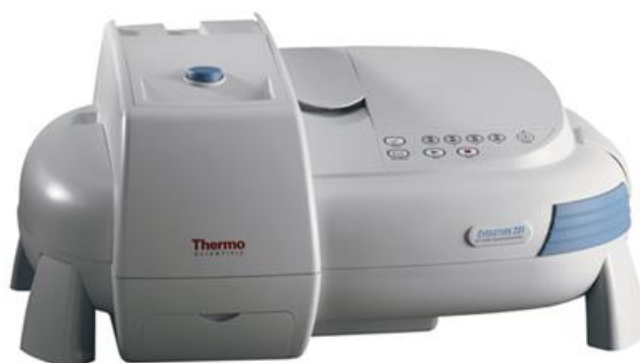
Rys. 23 Spektrofotometr laboratoryjny Thermo Scientific™ Evolution™ o rozdzielczości spektralnej 1 nm i zakresie spektralnym UV-VIS od 190-1100 nm.
