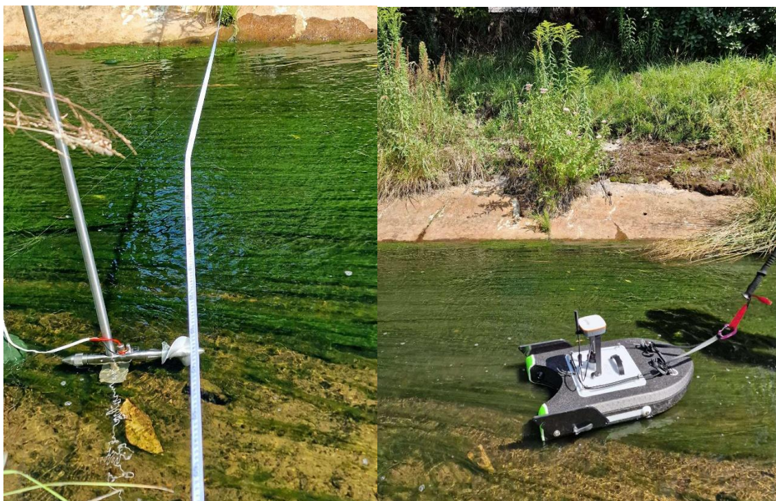
Fot. 1: Pomiar terenowy natężenia przepływu wód w Kanale Dąbrówka przy pomocy młynka hydrometrycznego (po lewej) oraz przepływomierza profilującego ADCP (po prawej).
