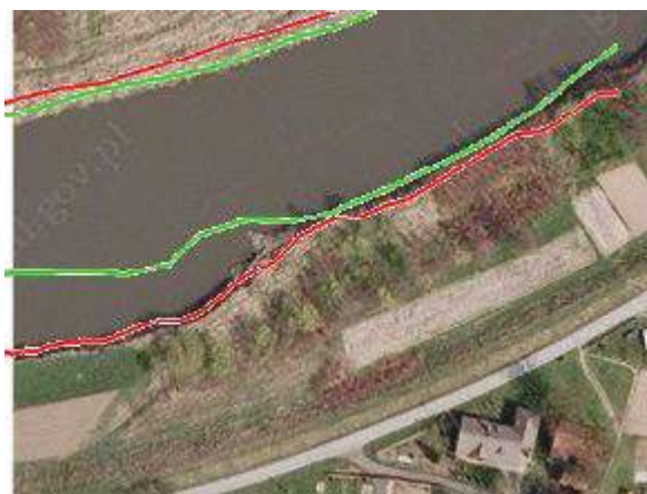
Rys. 1 Zmiana kształtu koryta rzeki w latach 1977-2009, na odcinku pomiędzy obrębem Czemichów i Pozowice. Kolorem zielonym zaznaczona jest linia brzegu ustalana w roku 1977, kolorem czerwonym brzeg w roku 2009. (A. Bieda i R. Hycer, 2012, s. 6)
