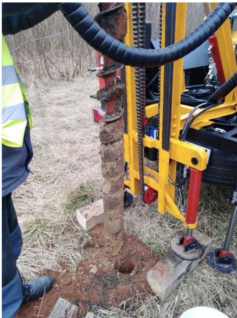
Rysunek 6. Pobieranie próbek gruntu przy pomocy wiertnicy mechanicznej metodą obrotową „na sucho”
