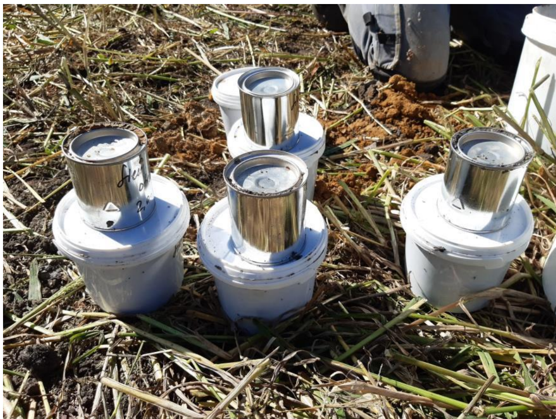
Rysunek 7. Próbkki gleby pobrane do badań laboratoryjnych zabezpieczone na czas transportu w odpowiednich pojemnikach
