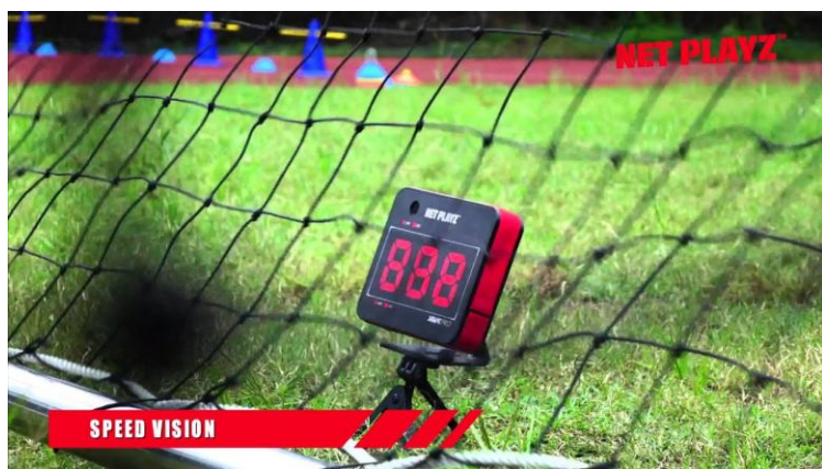
Fot. 19. Przyrząd do pomiaru prędkości kopniętej piłki. Źródło: mcourt.eu, dostęp: 30.08.2021.
