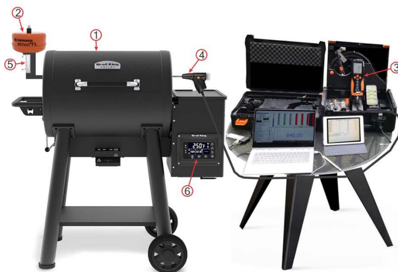
Ilustracja 6. Zestaw do analizy spalin i cząstek stałych. 1 – grill Broil King Pellet 400, 2 – analizator ATMON FL S.M.O.K., 3 – analizator Testo-2 LL, 4 – sonda analizatora Testo-2 LL, 5 – szklana węzownica chłodząca gaz, 6 – panel sterowania grilla. Zdjęcie grilla firmy Broil King
