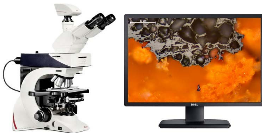
Ilustracja 1. Mikroskop Leica DM 2500P wykorzystywany w moich badaniach oraz zdjęcie brykietu z węgla drzewnego zanieczyszczonego substancją mineralną w odbitym świetle białym i imersji olejowej
