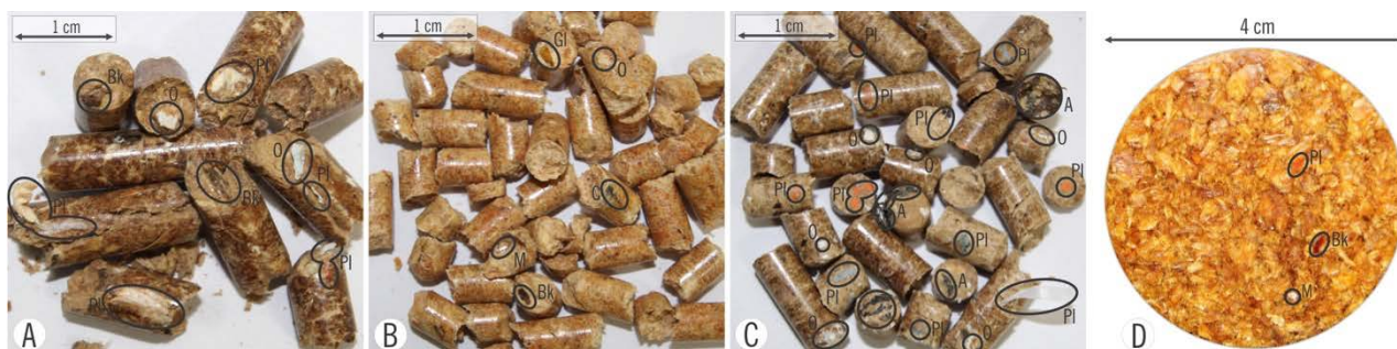
Ilustracja 2. Pellety drzewne o bardzo wysokiej zawartości zanieczyszczeń, które są widoczne nawet megaskopowo (A–C) i w zglądzie mikroskopowym (D). A – popiół, Bk – kora, C – węgiel, Gl – szkło, M – metal, O – spoiwo, Pl – tworzywo sztuczne
