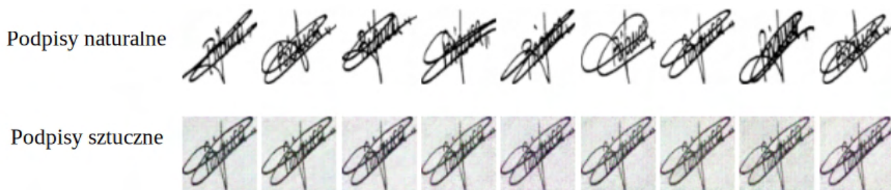
Rysunek 8.1.2. Przykład niskiej zmienności podpisów sztucznych, spowodowanej kopiowaniem przez sieć neuronową jednego z podpisów naturalnych (trzeci od prawej).
