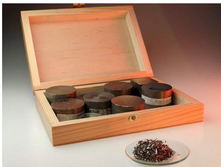
Rysunek 12. Materiały odniesienia w formie litych krążków oraz wióry próbki rzeczywistej dostarczone do analizy.
