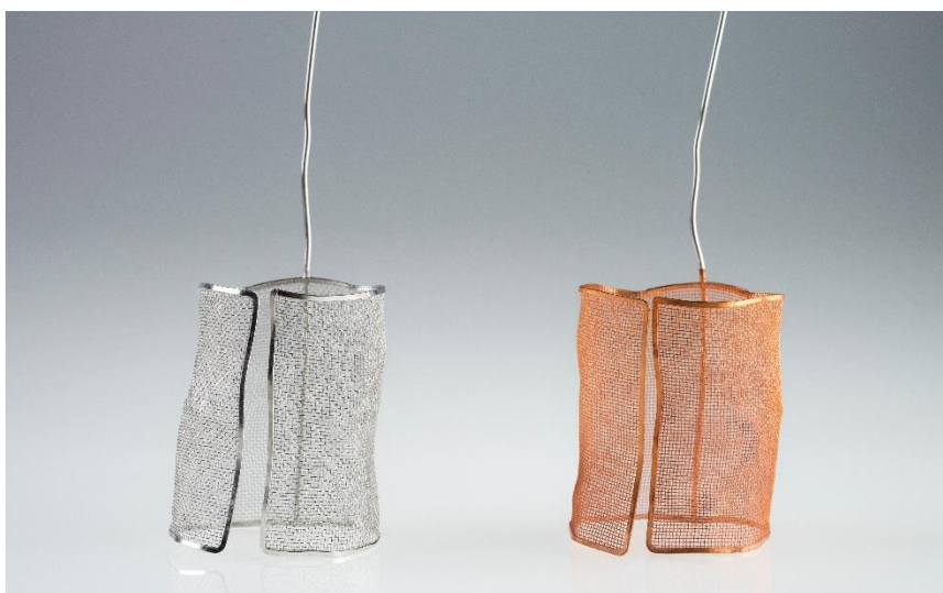
Rysunek 54. Elektroda platynowa przed (lewa) i po (prawa) elektrolizie.
