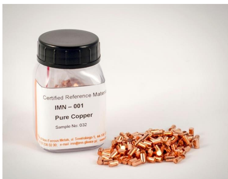
Rysunek 52. Certyfikowany materiał odniesienia miedzi wysokiej czystości IMN-001 wraz z fragmentem certyfikatu prezentującym skład.
