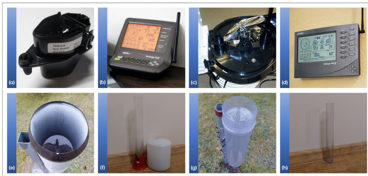
Rys. 7. Deszczomierze automatyczne z konsolami: (a, b) Davis Vantage Vue, (c, d) Davis Vantage Pro 2A. Deszczomierze manualne z miarkami: (e, f) deszczomierz Hellmanna, (g, h) Stratus. Opracowanie własne.
