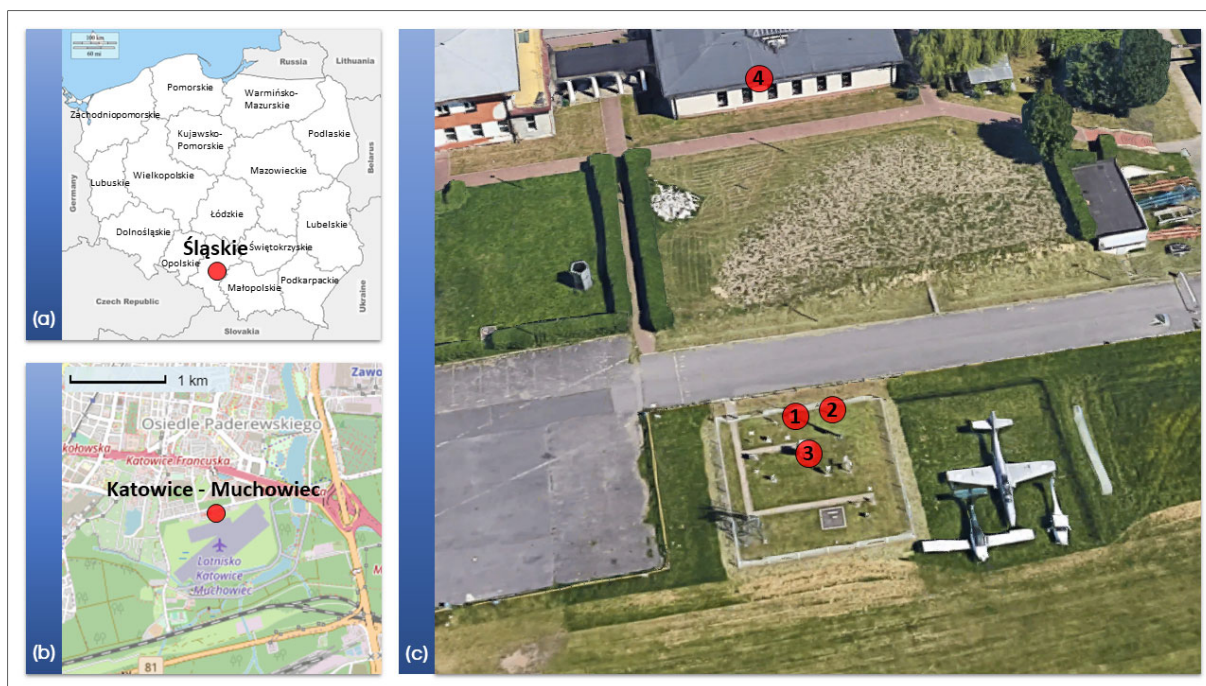
Rys. 13. Lokalizacja stacji (a-c): (c) 1 - amatorska stacja meteorologiczna Davis Vantage Pro 2A, (c) 2 - wiatromierz amatorskiej stacji meteorologicznej Davis Vantage Pro 2A, (c) 3 - klatka meteorologiczna stacji synoptycznej IMGW-PIB Katowice-Muchowiec, (c) 4 - lokalizacja konsoli amatorskiej stacji meteorologicznej Davis Vantage Pro 2A odbierającej sygnał z przyrządów pomiarowych. Opracowanie własne na podstawie map https://polska.geoportal2.pl/ i https://www.google.pl/maps .
