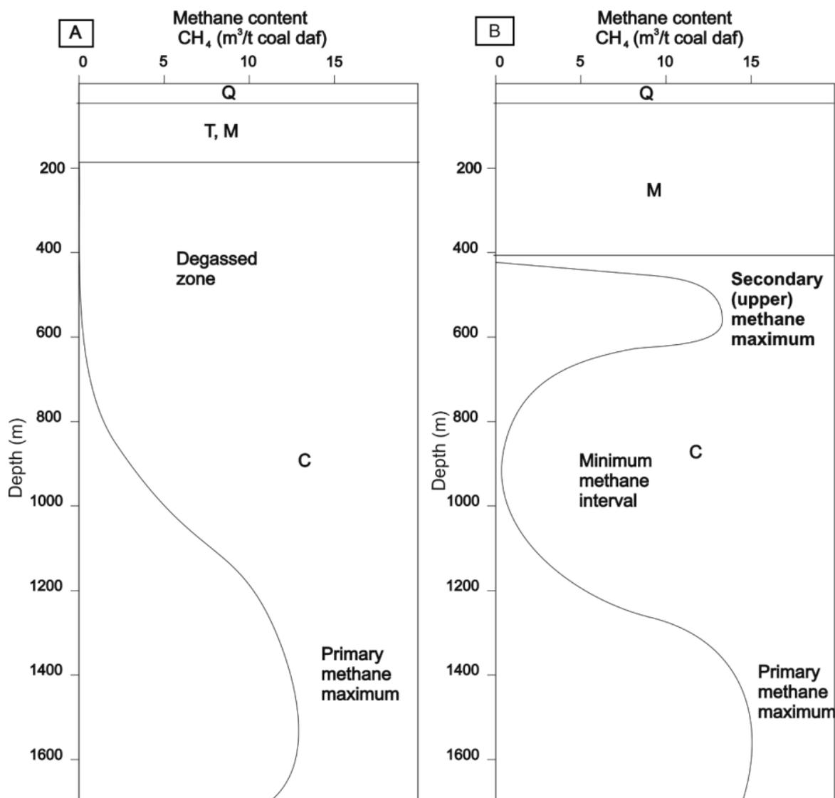
**Rys. 2** Pionowy rozkład metanoności GZW– model północny (A) oraz południowy (B)
