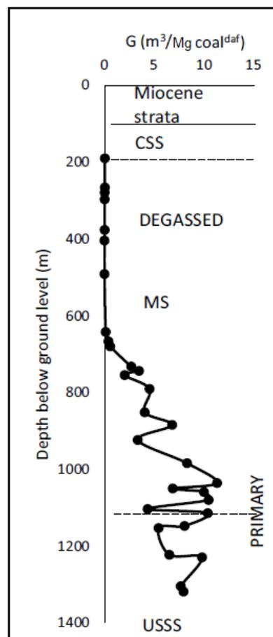
**Rys. 3** Pionowy rozkład metanonośności w otworze LG -23 (mod. Kędzior, Dreger 2019)
