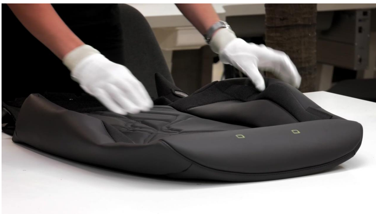
Rys. 59. Montaż tapicerki septycznej na stelażu fotela
