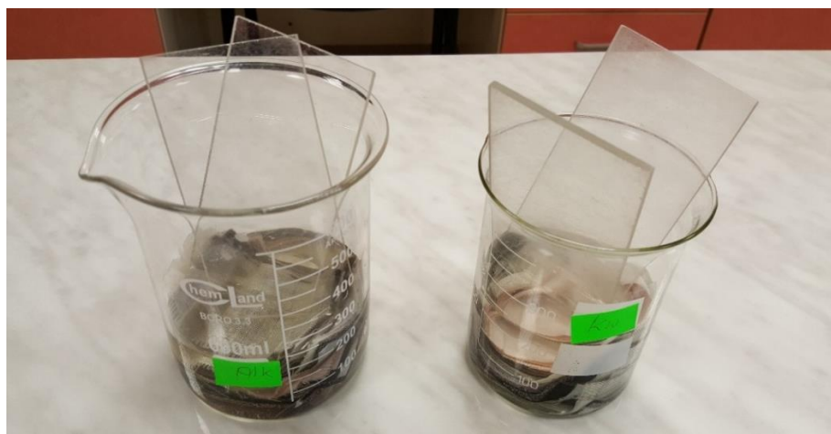
Rys. 55. Próbkę z alcantary zanurzone w kąpielach alkalicznej i kwaśnej
