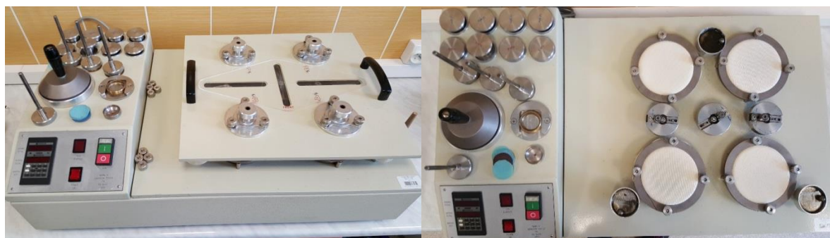
Rys. 50. Czterokulowy aparat Martindale'a do badań ścieralności wyrobów włókienniczych-płaskich
