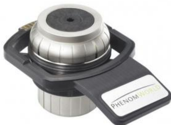
Rys. 15. Uchwyt próbki do wysokorozdzielczego obrazowania w wysokiej próżni, materiałów nieprzewodzących [41]
