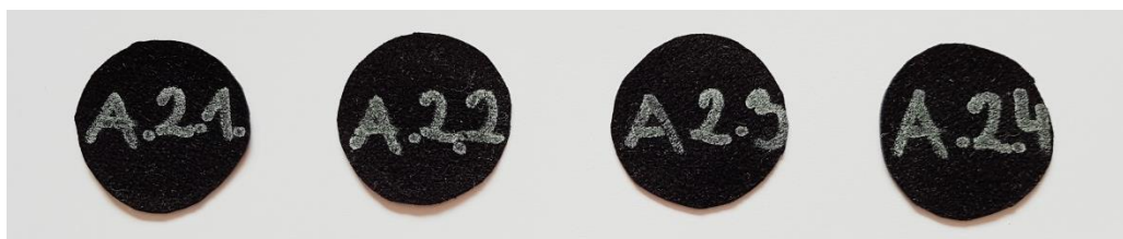
Rys. 51. Seria czterech próbek przygotowana zgodnie z normą PN-EN ISO 12947-1 [47], do badań ścieralności
