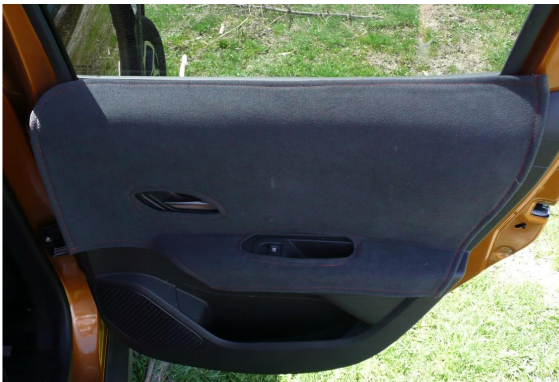
Rys. 66. Drzwi tylne pokryte materiałem septycznym
