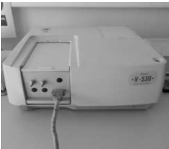
Rysunek 21 Spektrofotometr UV-VIS Jasco V-530
