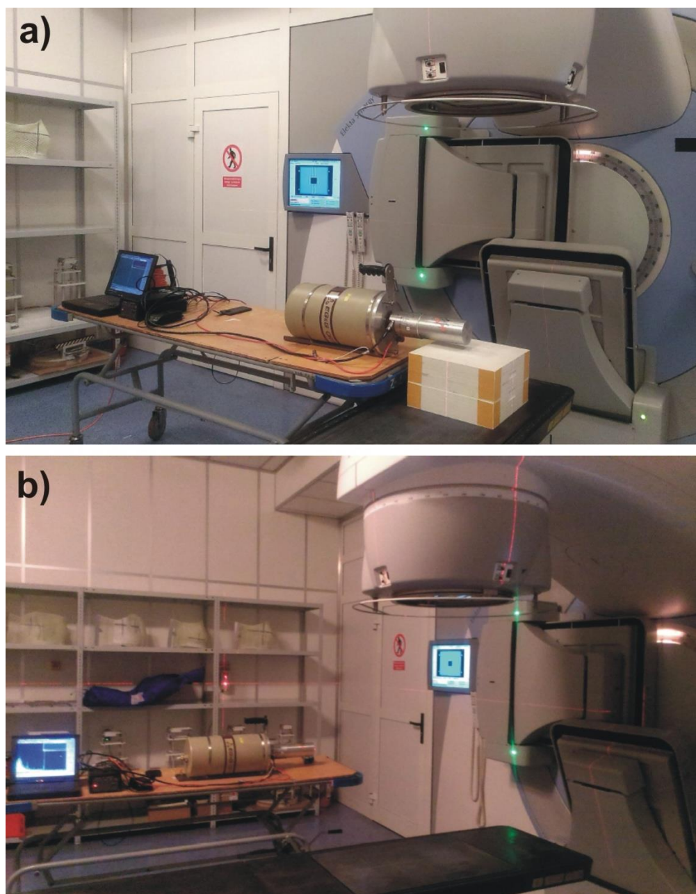
Rysunek 26: Widok układu pomiarowego do spektroskopii gamma w pomieszczeniu do radioterapii z akceleratorem Elekta. Pomiar z izocentrum obrotu głowicy Elekty (a), pomiar obok stołu terapeutycznego (b).
